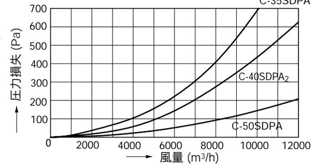
圧力損失曲線：給気
