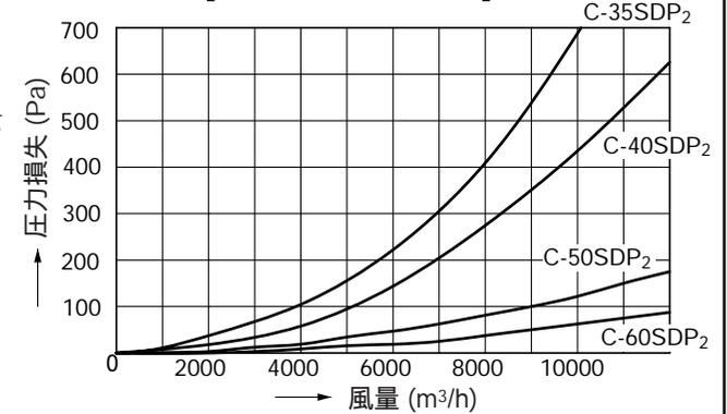
圧力損失曲線：給気
