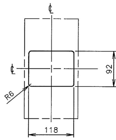
穴明寸法は、遮断器窓枠
