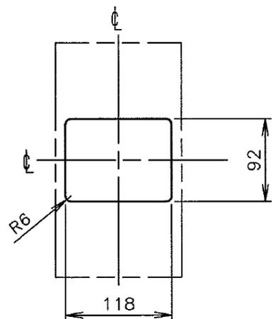
穴明寸法は、遮断器窓枠
