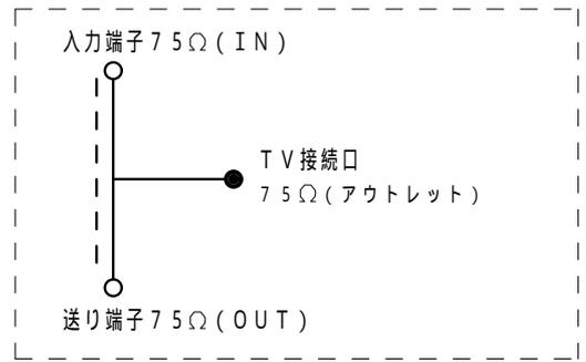
回路図 ( — — は電流通過経路を示す )
