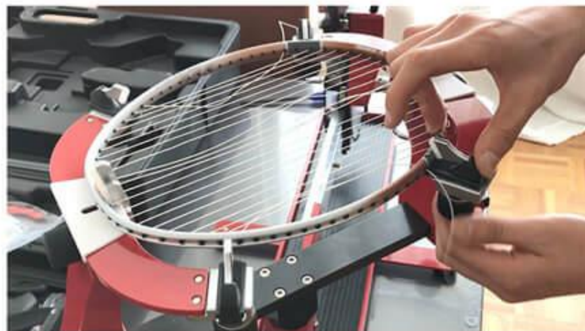
② 図の黒いつまみ(4カ所)をラケットの大きさに合わせて調整します
