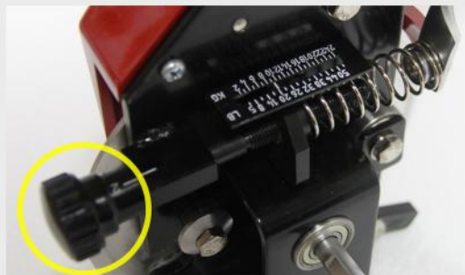
図の部分回すとテンション(張力)を調節できます。
