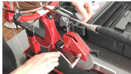
ガットチャックにガットを引っかけて、黒い部分が外れるまでハンドルを回し、テンション(張力)ををかけます。
