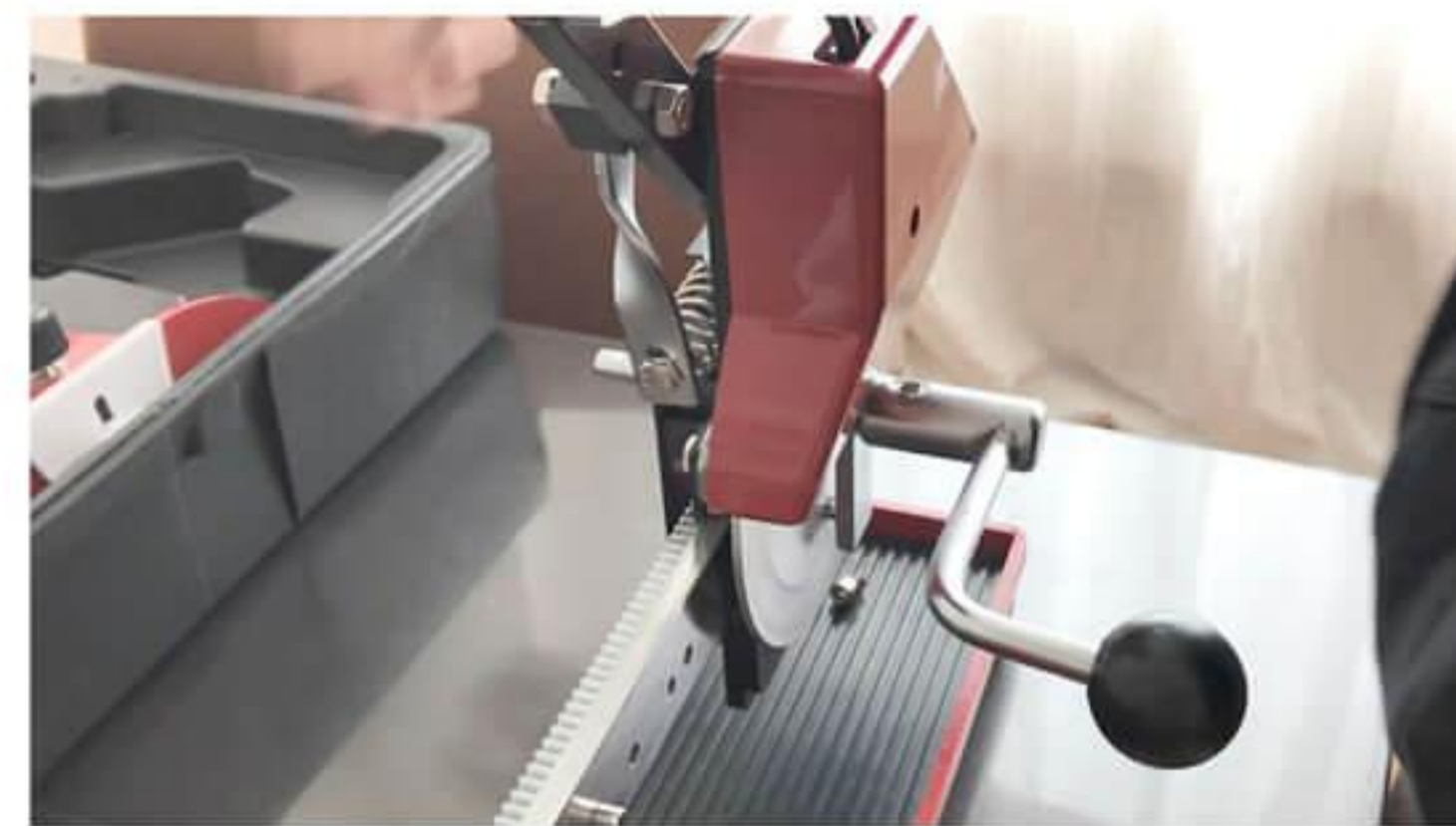
③ テンションヘッドを図のように差し込みます
