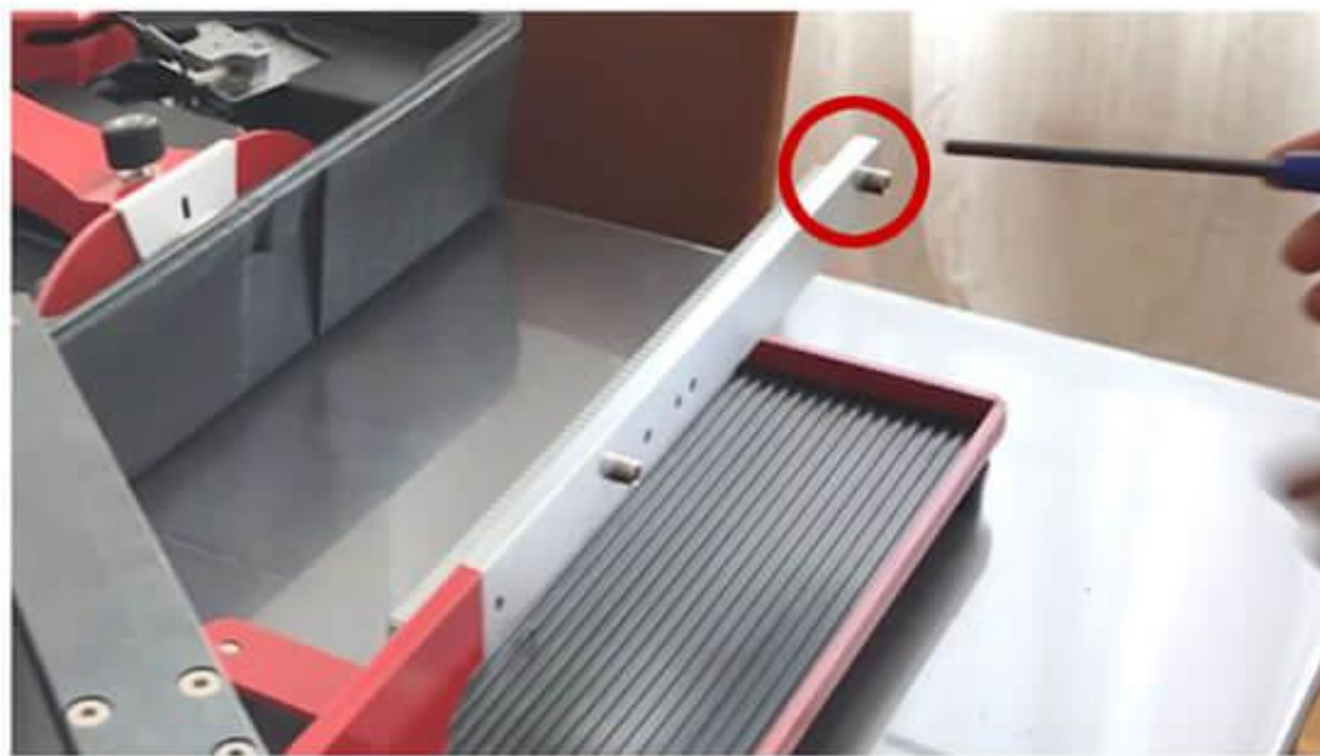
② 赤いマークの部分のネジを六角レンチを使って外します。
