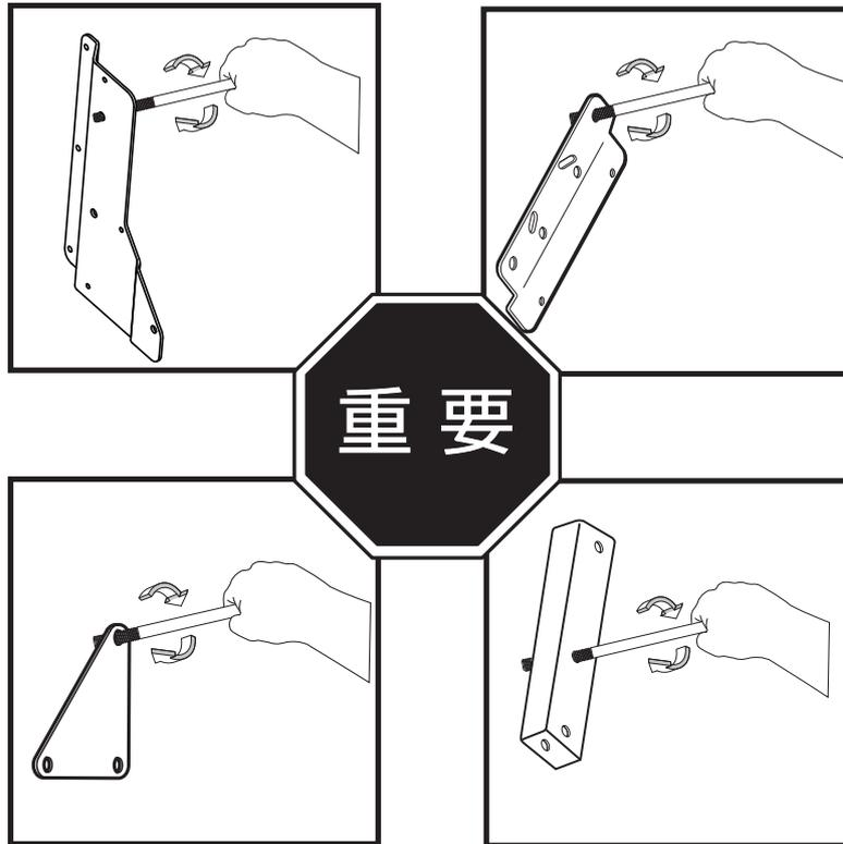
塗装を施してあるパーツについては、塗装の厚みでボルトが穴に入りにくい場合がありますので、上の図のようにネジのギザギザの部分だけを穴に通し、上下左右にこねるように回してください。穴の内側の塗装がはがれて、ネジが通りやすくなります。
