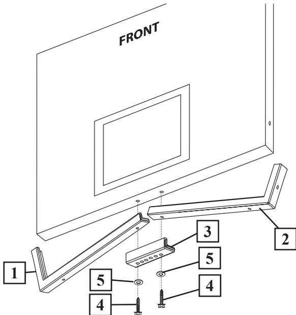
**2.** 下図のようにレフトボードパッド(1)、ライトボードパッド(2)をフラットワッシャー(5)、フラットワッシャー(5)、ネジ(6)を使用し固定してください。
