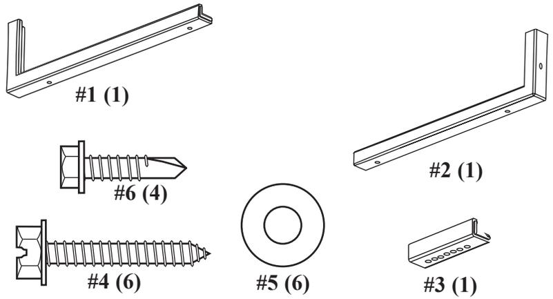
**1.** 下図のようにレフトボードパッド(1)、ライトボードパッド(2)、センターボードパッド(3)を並べフラットワッシャー(5)、ネジ(4)を使用し取り付けてください。
