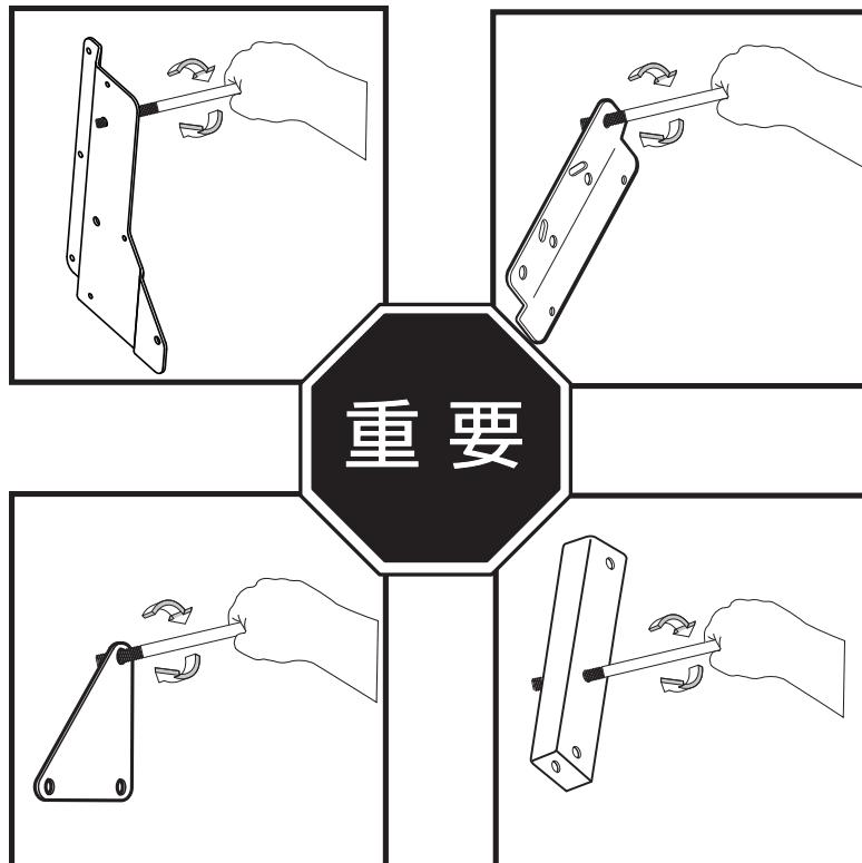
塗装を施してあるパーツについては、塗装の厚みでボルトが穴に入りにくい場合がありますので、上の図のようにネジのギザギザの部分だけを穴に通し、上下左右にこねるよう回してください。穴の内側の塗装がはがれて、ネジが通りやすくなります。
