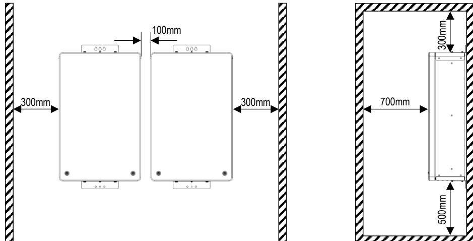
図 1 設置時の離隔距離
