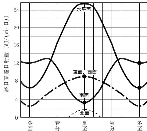
2. 北緯35度の地点における、春分・秋分の南中時の太陽高度は、約55°である。右図のように、南中時の太陽高度が55°の直達日射量をベクトルとしてとらえて考え、水平面と南向き鉛直面に分解した矢印の長さが、各向きの直達日射量の割合となる。したがって、右図より、春分・秋分の南中時(太陽高度55°)の時の直達日射量は、水平面 $J_H$ のほうが南向き鉛直面 $J_V$ よりも大きい。
