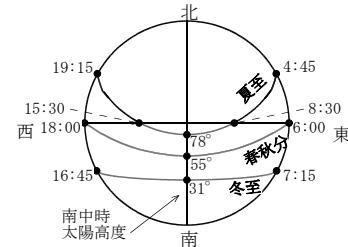
4. 建築物の形状が4時間日影となる領域に及ぼす影響は、南北方向よりも東西方向の幅によるもののが大きい。したがって、建築面積と高さが同じ建築物では、平面形状が正方形よりも東西に長い形状のほうが、4時間日影となる領域の面積は大きくなる。
