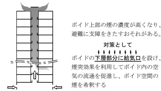
図 ボイド型建築物の煙突効果を利用した排煙
