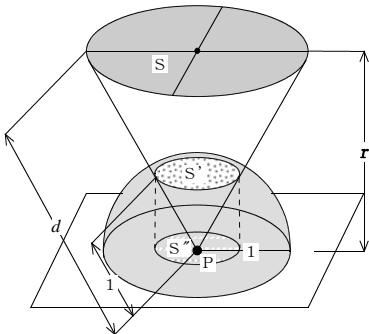
で、 $S'' = S' = S \times \frac{1^2}{d^2}$ であるため、 $C_A = \frac{S}{\pi d^2} \times 100 [\%]$ となる。
