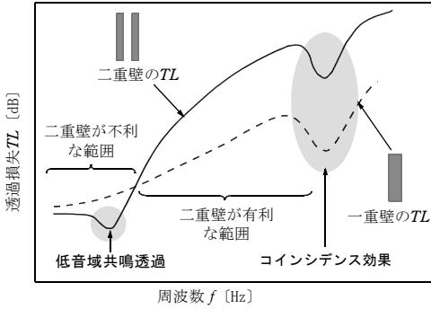
図 二重壁の透過損失の傾向
