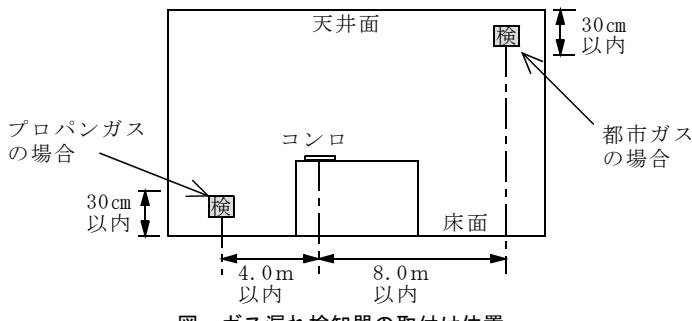
図 ガス漏れ検知器の取付け位置
