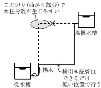
図 水柱分離を防止する配管計画
