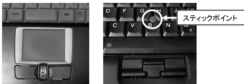
図 7-4 ノート PC のタッチパッド(左)とスティックポイント(右)
