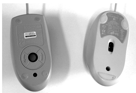
図 7-3 マウスのセンサー (左:ボール型, 右:光学型)
