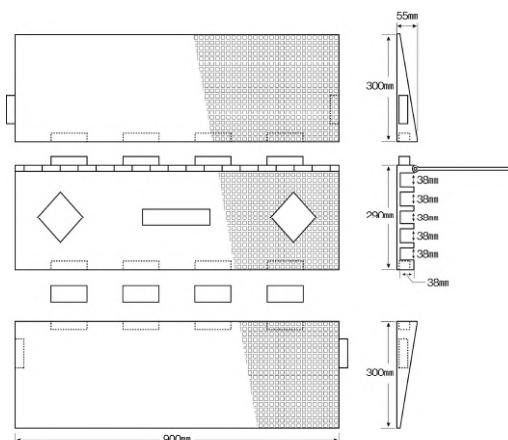
5本を超えるケーブルを収納できます。スロープ部分がセンターから分離しているので、センターとセンターを直接連結して収納ケーブルを増やすことができます。
