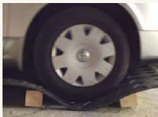
同じ板厚でも柔らかい敷板
