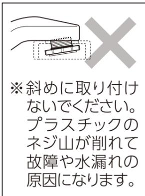
※斜めに取り付けないでください。プラスチックのネジ山が削れて故障や水漏れの原因になります。
