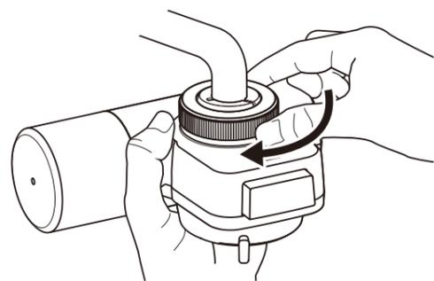
※取付ナットは確実に締め付けてください。
