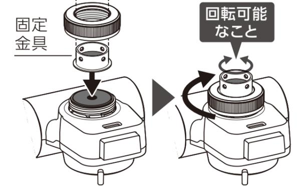
※固定金具が回転可能な程度で取付ナットを軽く締め付けてください。
