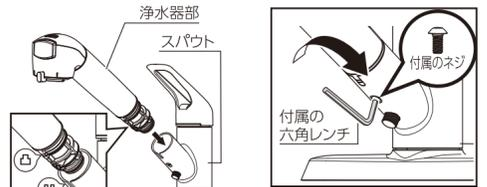
浄水器部の凸とスパウトの凹が合うように差し込み、付属の六角レンチで付属のネジを十分に締め込みます。
