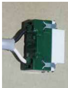
②写真に示す端子台の穴に銅線をまっすぐ入れ込み、銅線部が見えなくなるまで押し込む。
