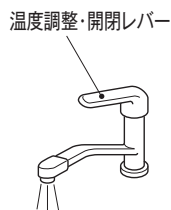
※イラストはワンレバー式の温度調整機能付き混合水栓の一例です。
