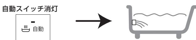
※自動運転が完了すると、浴槽にお湯が残った状態でも配管クリーン機能が行われます。
