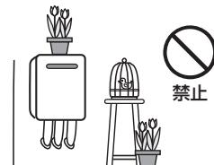
増改築などによって、排気ガスが直接建物の外壁や窓・ガラス・網戸・アルミサッシなどに当たらないようにしてください。変色・破損・腐食の原因になります。
