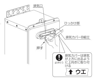
(2) 排気カバー A の裏側の穴(2 か所)に排気カバー B 組立の凸部が合うまで差し込み、固定してくだ さい。
