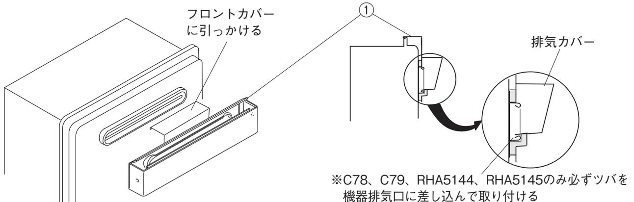
**2** ①で取り付けした排気カバーSETを②排気カバー取付板で取り付ける。
