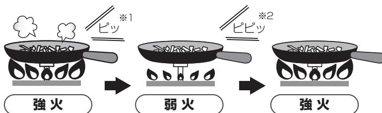
※1：最初に弱火になったとき、ブザーが“ピッ”と1回鳴ってお知らせします。鍋の温度が下がると再び強火（元の火力）に戻ります。
