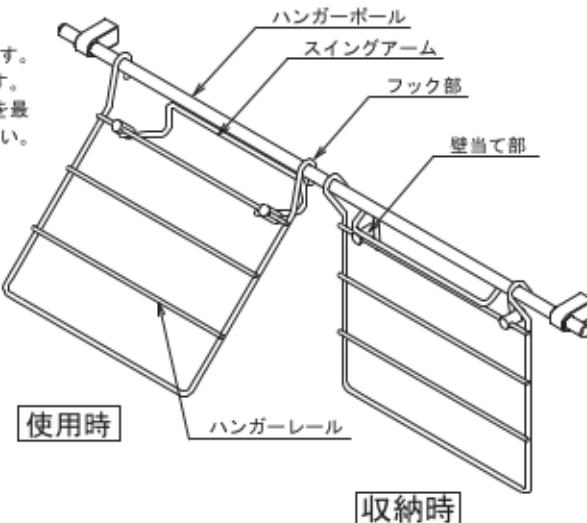
材質：18-8 ステンレス鋼 日本製
