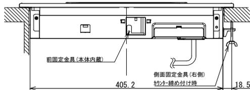
正面図 (左右両側が壁面の場合)
