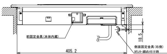
背面図 (左右片側が壁面の場合)
