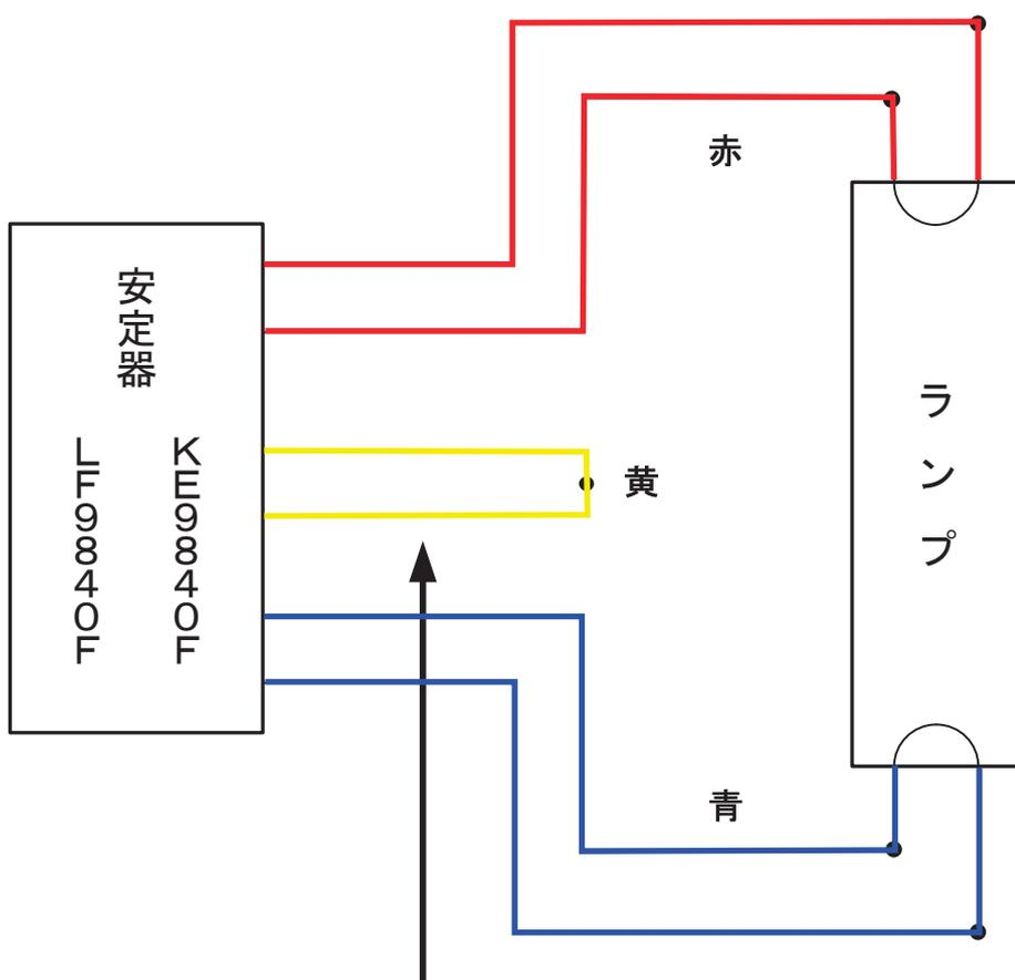
黄色線2本を短めに結線し、赤・青線を両側ソケットへ接続してください。
