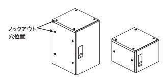
② 穴位置にプラスドライバーなどをあて ハンマーで叩くとφ10の穴を打ち抜くことができます。 ※連結する面以外の穴は打ち抜かないでください
