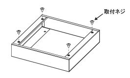
② ベースのネジ穴と穴位置を合わせるようにボックスを載せ 外した取付ネジで4箇所しっかりと固定してください。
