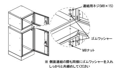
④ 連結後、ボックスの底板(ポストタイプは中間板)を再び取付けてください。
