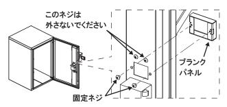
⑥ 取外したブランクパネルの位置に捺印用金具を入れ、先程取外した 固定ネジでしっかり固定してください。
