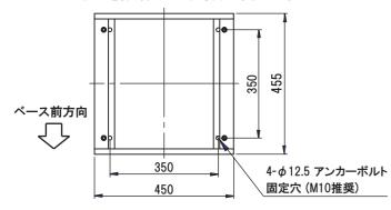
② ベースが水平に設置されるよう調整し、アンカー固定してください。
