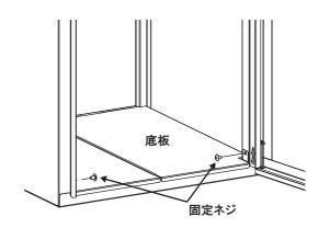
② ポストタイプの中間板も取外すことができます。 ※中間板を外しておくことで、連結する際の作業が行いやすくなります。 左右にある中間板を固定している固定ネジ(M4×6)を外し、ポスト正面にある 調整ネジを軽く緩め、ネジ裏側にあるロック金具を半時計回りに回すことで 棚板を取外すことができます。
