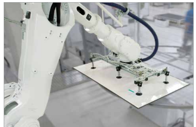
フラットパッドQNによる大判のプラスチック板の搬送
