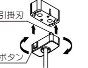
3. フランジを押し上げ、天井に密着させた状態でフランジカバーをフランジにねじ込んでください。
