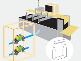
シールされたフィルムの冷却用の水量を管理します。
