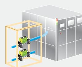
設定水量に満たない時は、警報を出力し、装置の過熱を防ぎます。アナログ出力で流量表示することも可能です。
