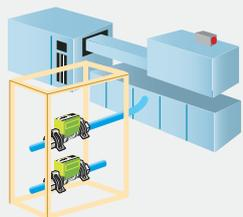
流体の温度は0~90℃の冷温水に対応しています。設定水量に満たない時は、警報を出力し、装置の過熱を防ぎます。
