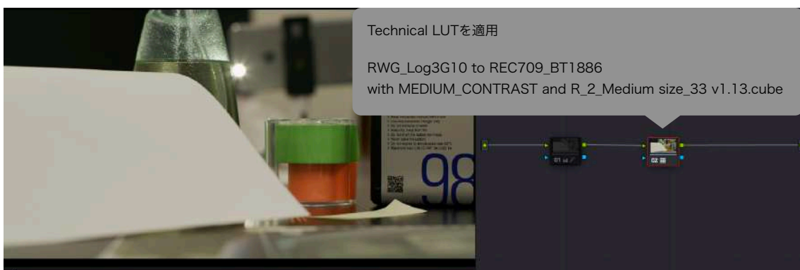
2つめのノードにTechnical LUTを適用し、Rec.709 / BT.1886、トーン「中」、ハイライトロールオフ「中」の表示に。
