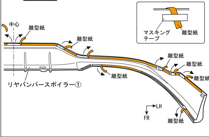
20. 図 15 のようにリヤバンパースポイラー①の両面テープの離型紙を矢印の方向に約30mm剥がしてマスキングテープ等で表側に貼付ける。
