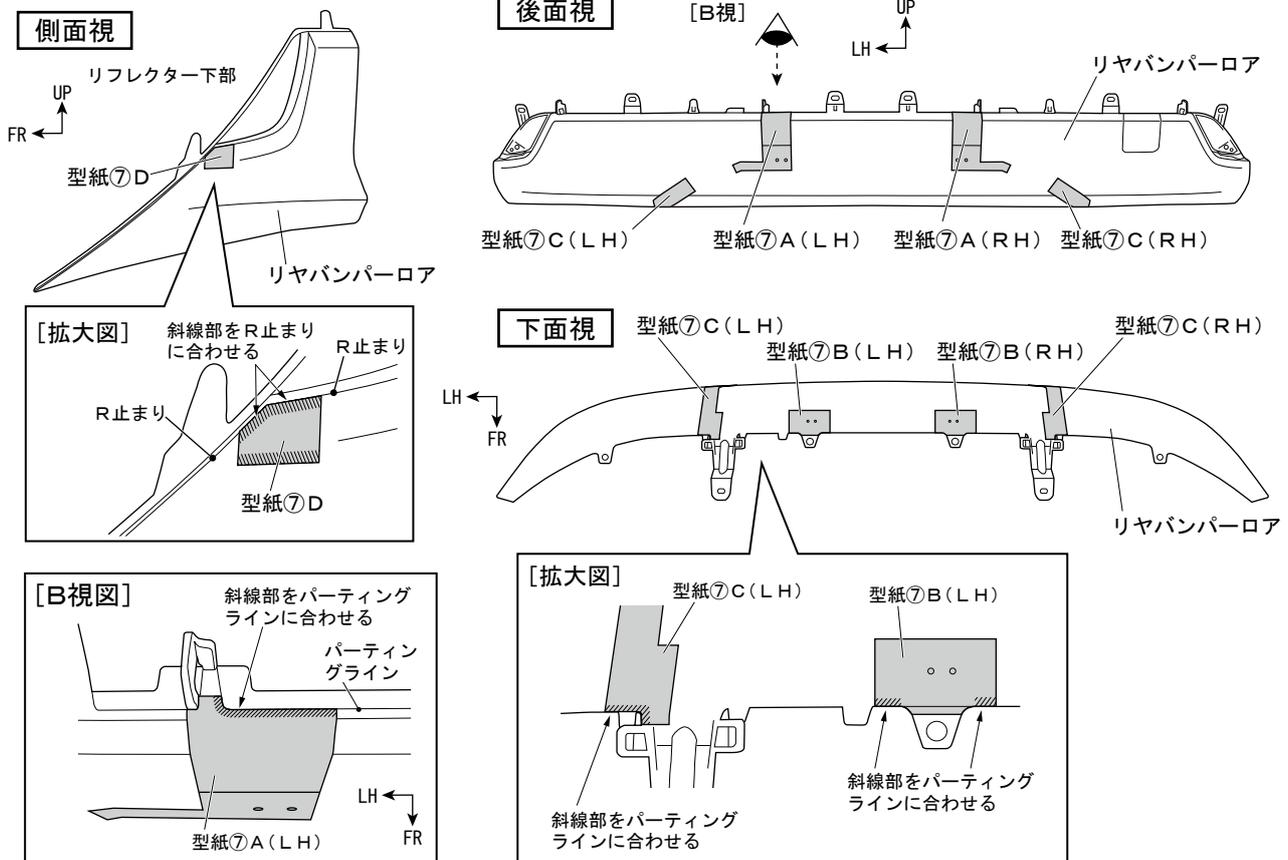
4. 図5のように型紙⑦A、B、Cのカットラインに合わせてリヤバンパーロアにマスキングテープを貼付ける。
