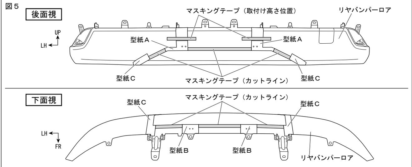
6. 図6のようにリヤバンパーロア後面及び下面の型紙⑦A、Bの穴あけ位置に合わせてケガキ針でマーキングし、 $\phi 4.0$ の本穴をあける。(左右各4箇所)
