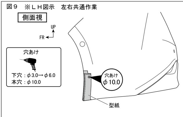
10. 図9のようにリヤバンパー側面の型紙⑦Eの穴あけ位置に合わせて下穴をφ3.0→φ6.0の順であけ、φ10.0の本穴をあける。（左右各1箇所）
