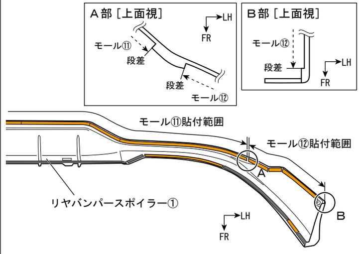
2. 図3のようにリヤバンパースポイラー①にモール⑪⑫の両面テープの離型紙を剥がしながら貼付け圧着する。モールは長めに設定されているので、長さを合わせてハサミ等で切り落とす。
