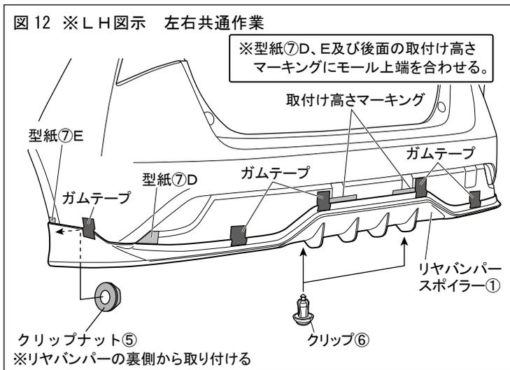
15. 図 12 のように型紙⑦D、E及び後方の取付け高さマーキングに合わせてリヤバンパースポイラー①を車両にあて、側面をクリップナット⑤、下面をクリップ⑥で仮止めし、ガムテープ等で仮固定する。
