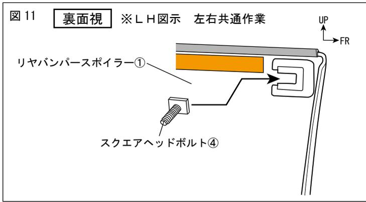
14. 図 11 のようにリヤバンパースポイラー①にスクエアヘッドボルト④を取付ける。
