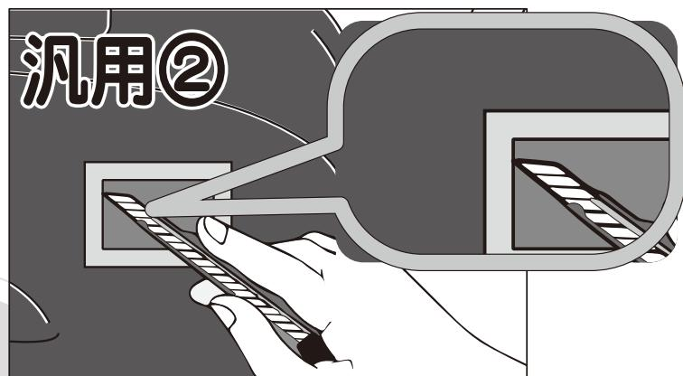
汎用②：その部位に本汎用製品付属の、型紙シールを貼り付けてシール内径に沿って四角穴をあけます。その際に鋭利な刃のカッター等で作業してください。
