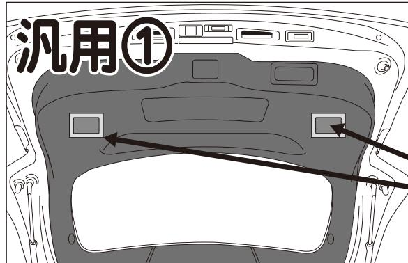
汎用①：装着(点灯)させたい部位(パネル等)を車輛から外します。その際に、装着部位の後方スペースに2cm以上の空間があるか確認してください。本製品を装着した場合に突起が発生するので干渉しないようにスペースが必要となります。
