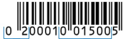
先頭2桁を検知してNON-PLUバーコードと認識します
