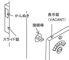
**3** かんぬきが入まっているか確認し、接続棒を表示錠裏側のスロット穴に入れながら、表示錠をドアの外側に取り付けください。
