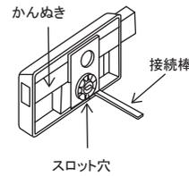
**2** 接続棒を回転錠のスロット穴に差し、ドアの内側に取り付けます。
