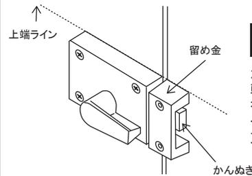
**4** かんぬきを最大まで引き出し、回転錠本体の向かい側に、留め金をスライド錠本体と上端の高さが揃う位置に固定し、戸枠に木ネジで取り付け下さい。
