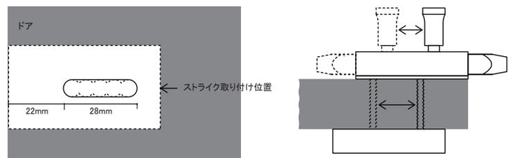
**2** 接続棒をスライド錠のスロット穴に取り付け、ドアの内側にスライド錠を取り付けます。取り付けの際に、接続棒がドアの外側の面から5~9mm突き出る長さに接続棒をカットしてください。
