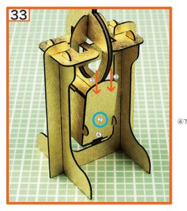
②○の辺りを押さえて ③下に押し下げます ④下突起がしっかりはまっている事を確認します ※重り調整等でフタをはずす際は
