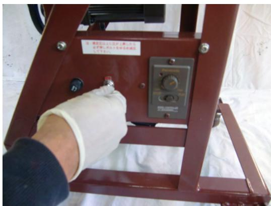
9バーナーに点火し(中火)次にモーターのスイッチをONにします。
