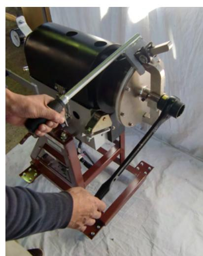
8釜を水平な状態に戻し、しのを使ってしっかりと締めます。
