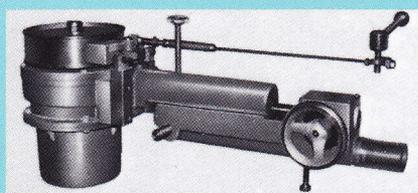
モーターの回転力をスピンドルへ伝達するためにナイロンエンドレスベルトを使用しており、スピンドルプーリー、モータープーリーに最適な状態で掛けられるように、あらゆる工夫が施されています。モーター内部で発生した風がヘッドへ導かれ冷却と切くずを排除します。
