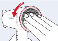
本体をしっかり持ち、吸込口カバーを「OPEN」の矢印の方向に回して取り外します。
