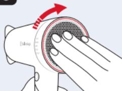
吸込口カバーの溝と本体の突起部3点をあわせてはめ、取り外した時と反対に回して取り付けます。
