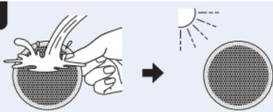
吸込口カバーを流水できれいに洗い、布等で拭きとった後、十分に乾燥させます。
