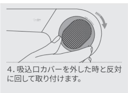
4. 吸入口カバーを外した時と反対に回して取り付けます。
