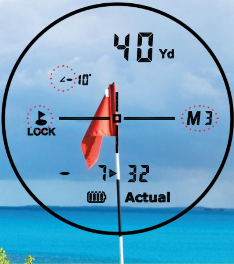
★★★ 傾斜切替スイッチをスライドすると液晶画面に「M3」が表示されます。「M3」表示を確認後、目標(ピン)までの間に障害物がない状態で計測をして下さい。※モード表示が「M1」「M2」の場合はモードボタンを押して変更して下さい。 **23**
