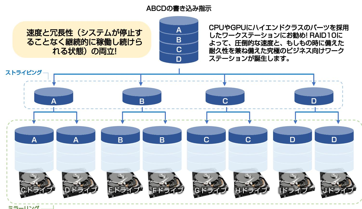
高速化、大容量化に対応するRAIDO (ストライピング) と、耐障害性に優れたRAID1 (ミラーリング) とを組み合わせた方式です。ストライピングによりディスクアクセスを複数のディスクペアに分散処理させるためパフォーマンスが向上します。ストライピングで束ねられた各々のミラーリンググループを「スパン」と呼び、RAID10では、同一スパンのハードディスク2台が同時に障害とならない限り、データは保全されます。障害時の回復作業も安全に短時間で済ませられるため、HPC用途のファイルサーバーなどで多く用いられています。
