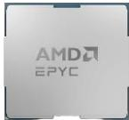
96コア192スレッドで動作するサーバー向けCPU。基本クロックは2.4GHz、最大クロックは3.7GHz、全コア起動速度は3.55GHz、ソケット数は1P/2P、TDPは360W。ソフトウェアが起動・実行され、重要なデータにアクセスするときに、潜在的な攻撃の可能性を最小限に抑えるのに役立つ「AMD Infinity Guard」を採用。PCI ExpressバージョンはPCIe 5.0 x128。
