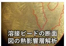
溶接ビードの断面図の熱影響層解析
