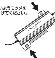
3. LEDバルブ取り付け後、車両のウインカーコネクタを外し本製品を割り込ませてください。
