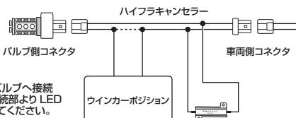
4. 2.で取り付けた抵抗のステー部分に両面テープを貼り付け、車両側金属面に貼り付けてください。
