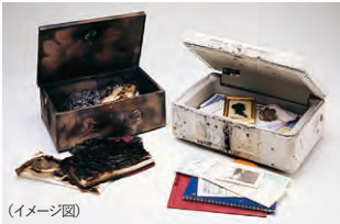
(イメージ図) 非耐火製品(左)と センター耐火保管庫(右)の耐火実験後
