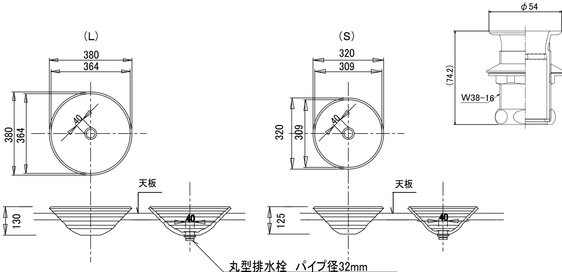
洗面台の天板に穴を開け、設置する場合の開口寸法(参考)
