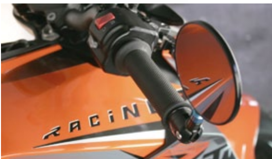
バーエンドスライドアダプター スライドすることによりハンドルに固定します
