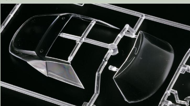
◀ウインドウは、フロントとサイド／リアの2ピース構造。1ピースだと塗装の厚みなどでボディに収まりにくくなることがあるが、2ピースだとそういった場合でも調整がしやすい。ウインドウパーツの透明度は高く、ピラーとの合いまばっちり。フロントウインドウも接着や貼り付けがしやすいように上側に隙れる部分が設けられている
